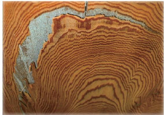
さて、厄介なのは、丸太を製材した際、この目まわり部分にかかると写真のように板からくり抜かれたような形状で分離してしまうことです。しかもこの割れは直線ではなく内部に回りながら入り込んでいるため、その部分の接着が極めて難しく、家具材・建築用材には使いづらくなり、屋久杉を加工する上での「難点」となっています。
